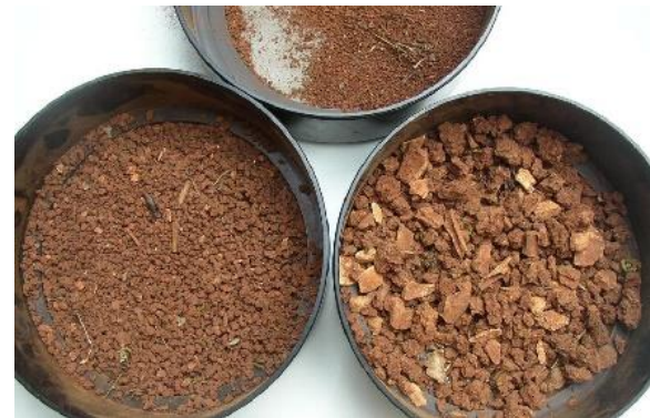
Exemples de refus de tamis de différentes tailles
